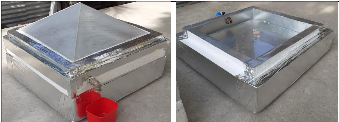
Figura 1: Dessalinizador Solar de Água. Fonte: Autor (2019).
