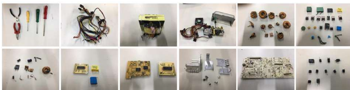
Figura 3. Principais componentes eletrônicos de impressora jato de tinta quarteados
