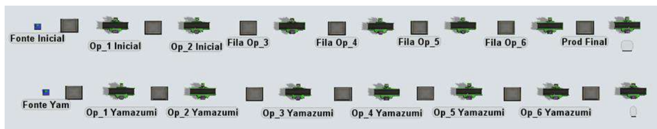
Figura 2. Modelo 3D da linha de desmontagem no software FlexSim.
